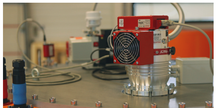
Abbildung 5: Turbopumpe, Drehschieberpumpe und Pirani-Messröhre von Pfeiffer Vacuum im Einsatz bei Levisys
