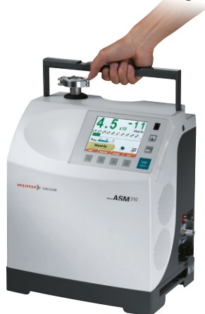
Abbildung 6: Mobiler Helium-Lecksucher ASM 310 von Pfeiffer Vacuum
